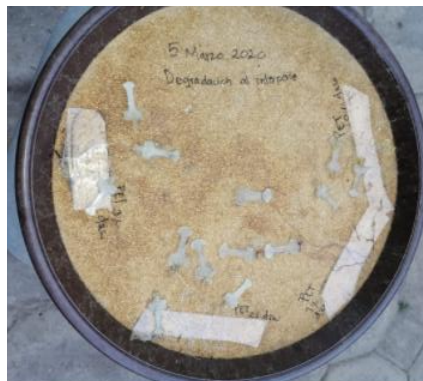
Figura 3 Charola con probetas expuestas al Intemperie
