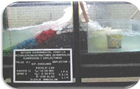
Figura 5. Ensayo 11, serie 2, con deflector número 1.
