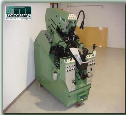
Figura 3: Máquina de montar con puntas hidráulicas, (máquina original).
