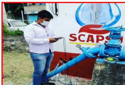
Figura 7. Obtención del gasto con un aforo puntual con caudalímetro ultrasónico.
