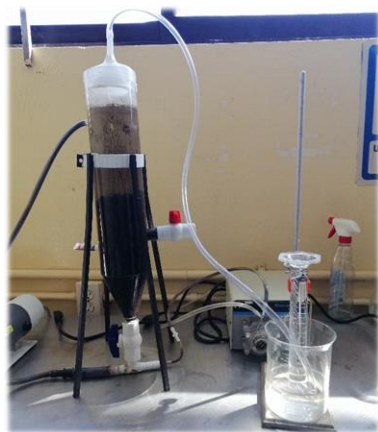
Figura 2. Reactor FFA en operación por lotes.
