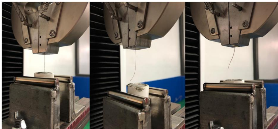
Figura 5.- Prueba de extracción de fibra, pull out
