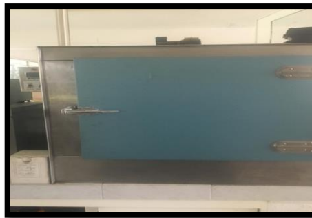
Figura 2 Estufa (Termodegradación), marca OMRON, donde se realizó la Termodegradación
